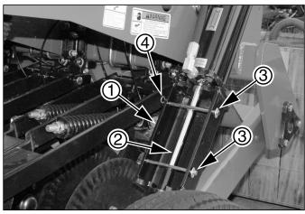
Figure 16 Lift Cylinder Lock (RH)
